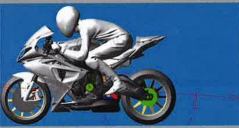
Die Mehrkörpersimulation (MKS) ermöglicht auch Berechnungen von Rundenzeiten auf detailgetreu hinterlegten Rennstrecken. Dabei können am Computer unzählige Parameter verändert werden wie beispielsweise Geometriedaten, Schwerpunktlage, Windeinflüsse, Übersetzungen, Motorpower...
