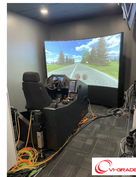
米国拠点設備 VI-grade製 COMPACT FSS(Full Spectrum Dynamic Simulator)
